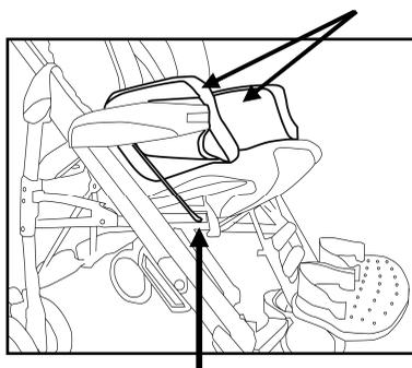
Posizione bullone di bloccaggio dello scorrimento della seduta
