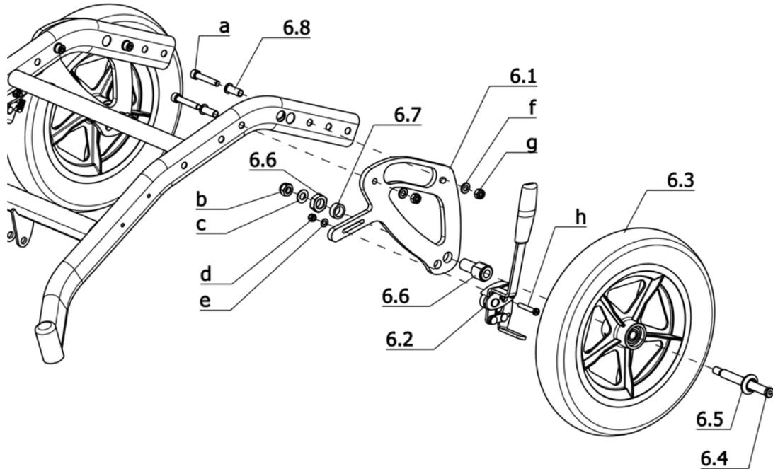
**U-Bg.: Code 641-815-902; festverschraubte Räder mit Druckbremse - 12½" Räder - pannensichere PU Bereifung**
