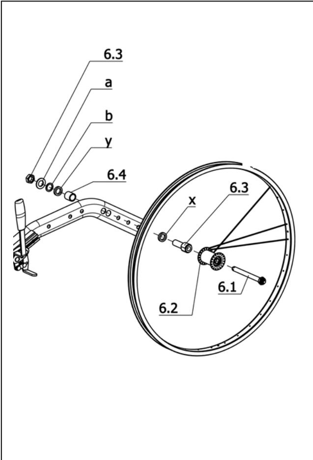
**U-Bg.: Code 651; abnehmbare Räder (Steckachse)**
