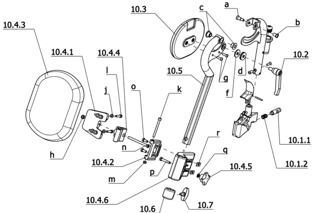
**U-Bg.: Code 92; abnehmbare höhenverstellbare Beinstütze, abschwenkbar**
