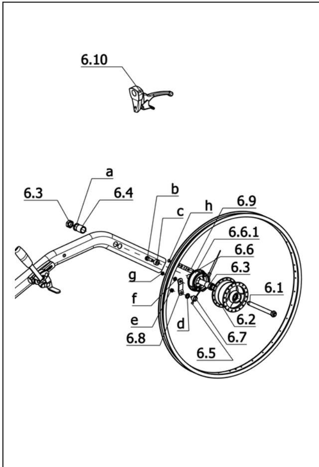
**U-Bg.: Code 706; Trommelbremse abnehmbare Räder mit 2 Hebel für Begleitperson**
