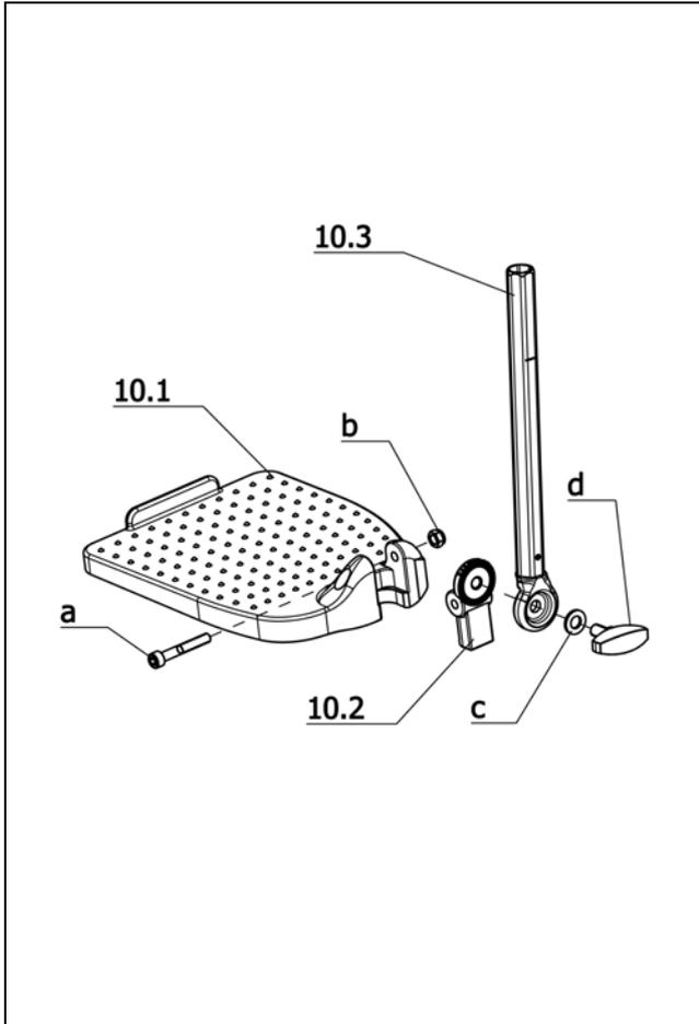
**U-Bg.: Code 128-798; Unterschenkellänge kurz – Fußplatten
