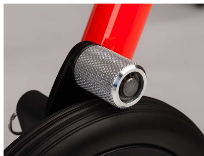
Μηχανισμός με επιλογή για αποτροπή της κύλισης προς τα πίσω.
